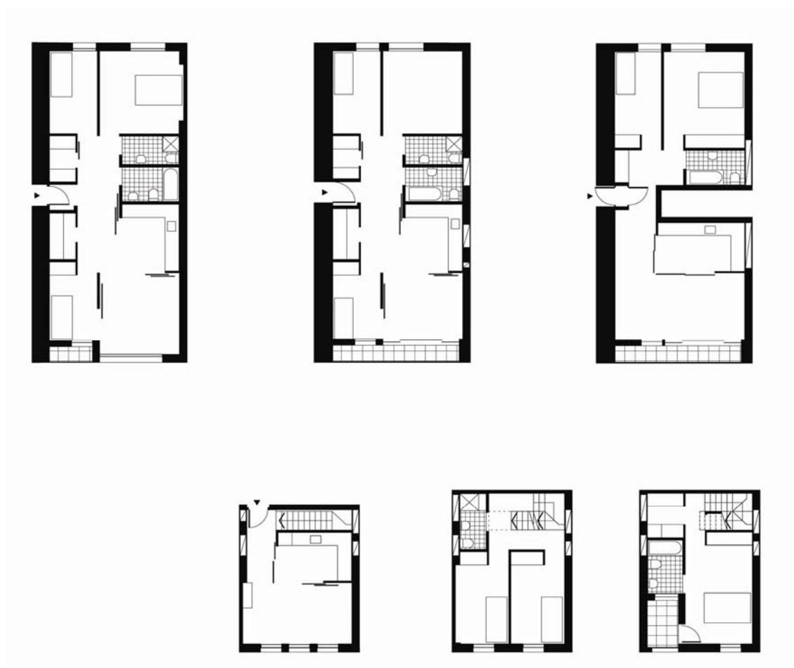
Figura 5.1.5. Plantas do pavimento tipo (pavimentos 2º - 11º) dos blocos da extremidade e plantas apartamento duplex.
