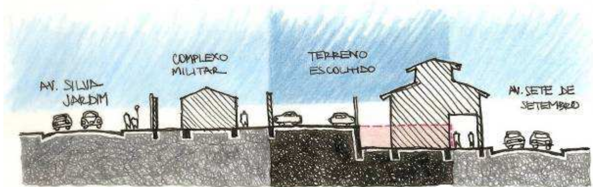
Figura 7.1 – Croqui do corte do terreno com suposição dos perfis topográficos atual (em preto) e antigo (em vermelho). (FONTE: A autora, 2009)
