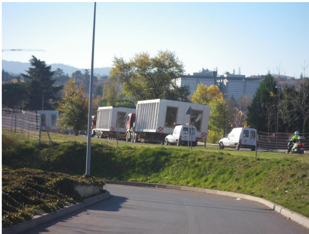
FIGURA 86 – TRANSPORTE DOS MÓDULOS EM CAMINHÃO. FONTE: ARCHDAILY, 2013.
