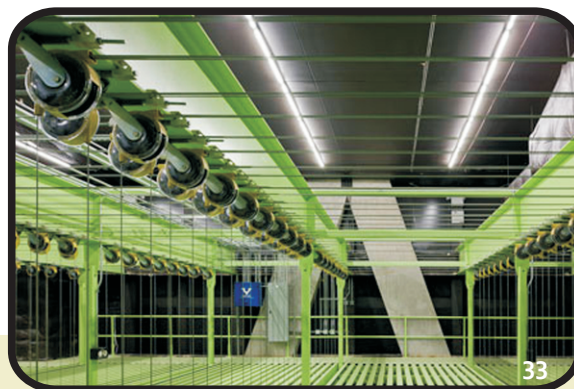
Figuras 32 e 33 - Sistema mecânico para movimentação dos camarotes e cenários.
