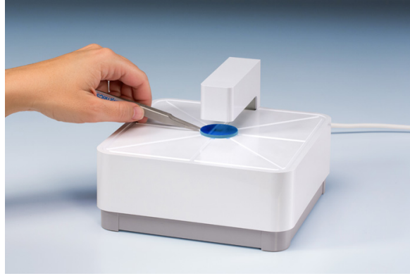
Figura 3.5 – Equipamento de bancada para realização de medidas de refletividade, transmissão e da espessura das amostras. [26]
