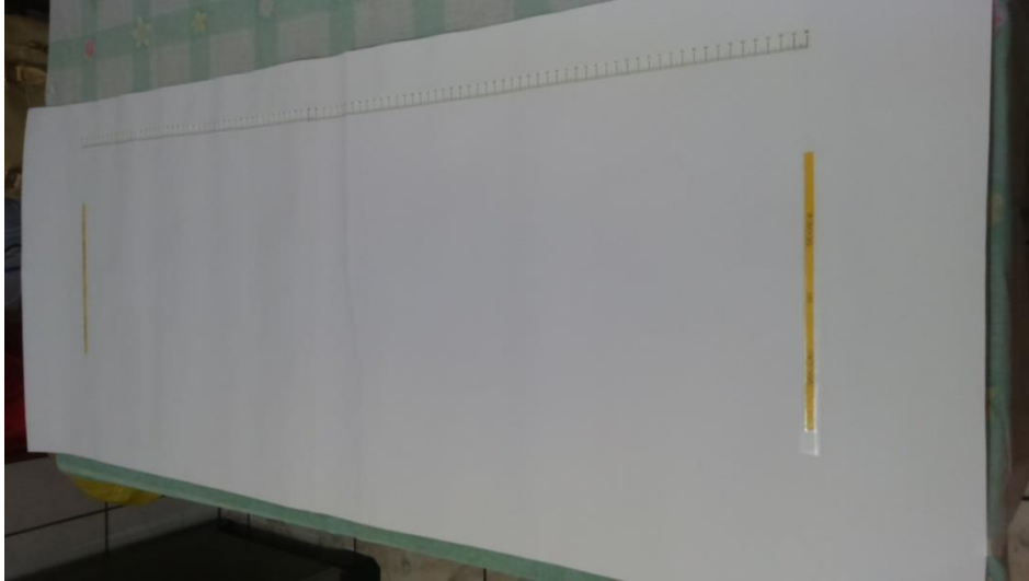
FIGURA 13 – BASE DE CARTOLINA COM A FITA MÉTRICA PARA FACILITAR O POSICIONAMENTO DA BARREIRA, FORAM MARCADAS A POSIÇÃO DO SENSOR E A DISTÂNCIA DE CALIBRAÇÃO. FONTE: O autor
