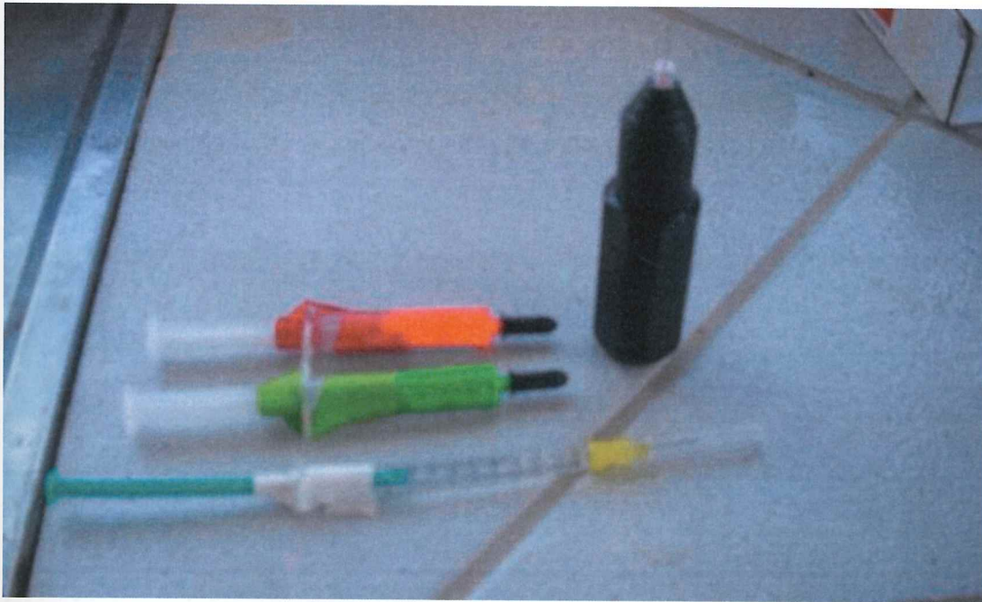
Figura 4. Sistema de marcação VIFE: seringas, carregador e injetor manual de elastômero.
