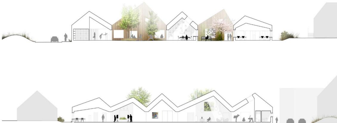
**Figura 61:** Cortes com destaque para aberturas zenitais.
