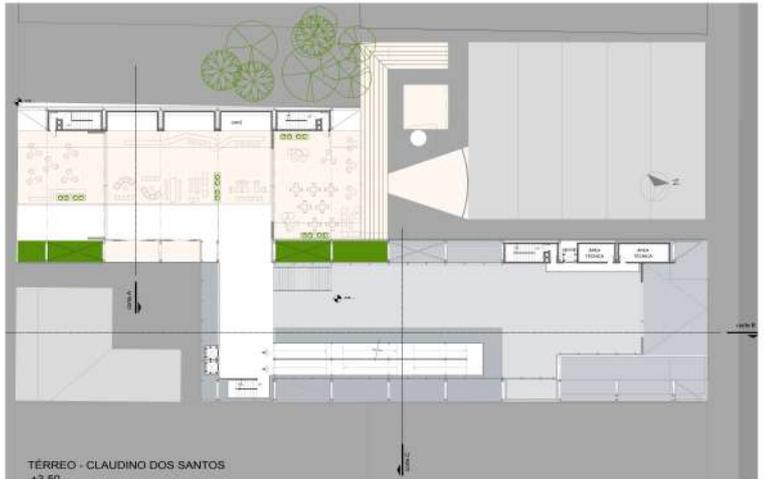
O edifício está organizado através de módulos de 7,50 m de eixo a eixo das treliças. Cada vão deixado entre as treliças é também utilizado para núcleos de circulação, instalações sanitárias e áreas técnicas necessárias. Por meio dessa modulação, pode-se maximizar a área livre destinada à permanência e por conseguinte, alcançar uma fluidez espacial maior.
