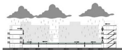
Corte BB - Captação de água da chuva
