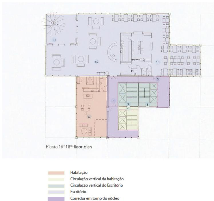
FIGURA 3.2.3: planta 18° andar. A planta demonstra a flexibilidade na distribuição das funções devido à disposição do núcleo.
