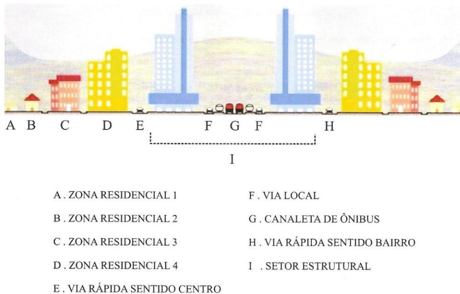
Figura 52: Corte esquemático dos Eixos Estruturais de crescimento de Curitiba
