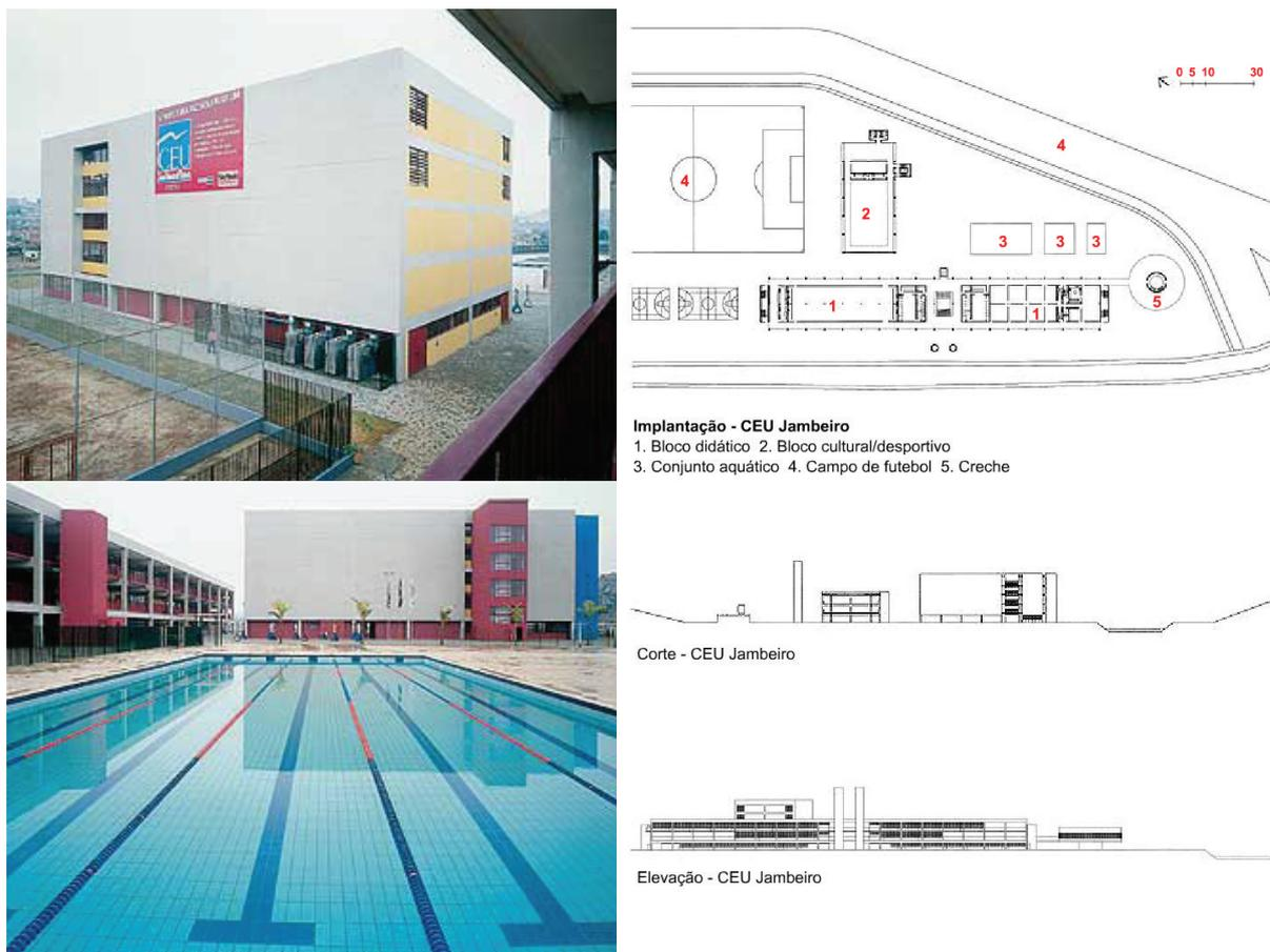
FIGURA 148 – CEU Jambeiro em São Paulo. Fotos do edifício e da piscina (a esquerda). Implantação demonstrando a variação que o módulo-padrão pode ter dependendo do terreno. Corte e elevação.
