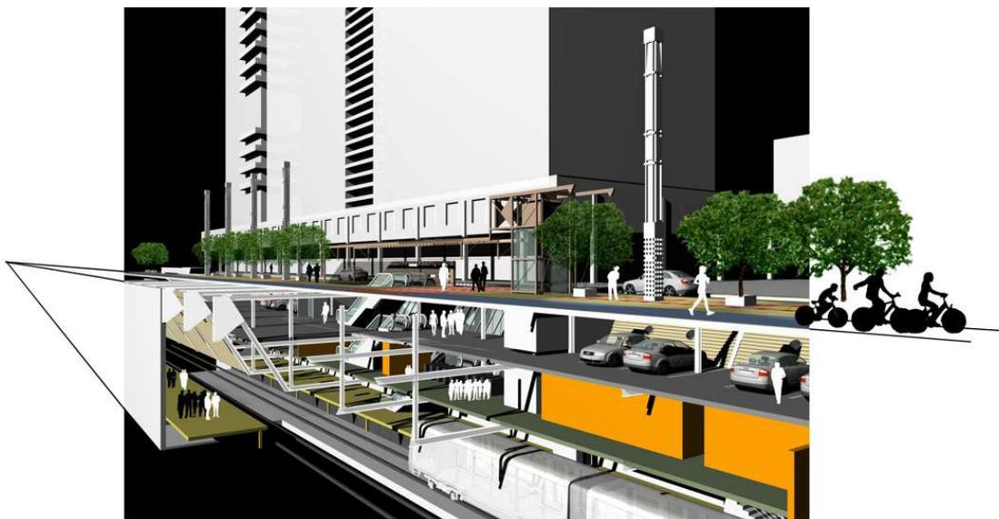
FIGURA 61: Corte em perspectiva do metrô.
