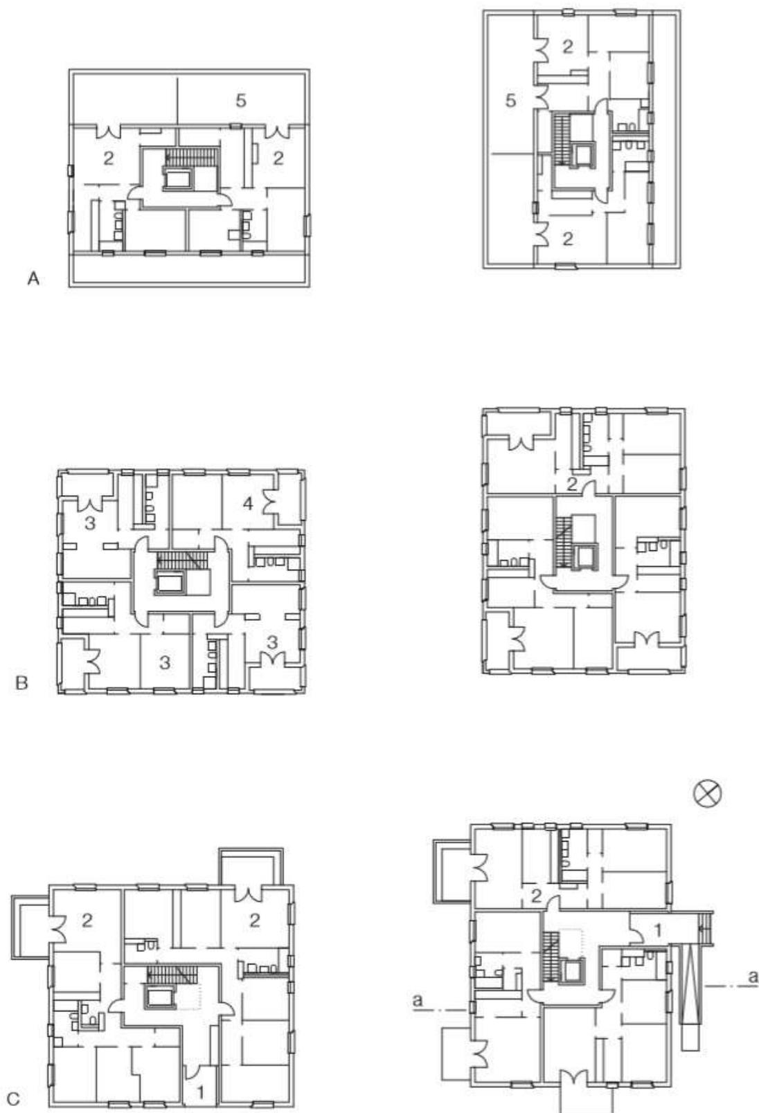
**Figura 3.2.7** – Plantas do pavimento de superior [A], pavimento-tipo [B] e pavimento térreo [C], em que se pode observar: os acessos [1], os apartamentos genéricos [2], os apartamentos destinados a idosos [3] e os apartamentos para deficientes [4], além do terraço de cobertura [5].
