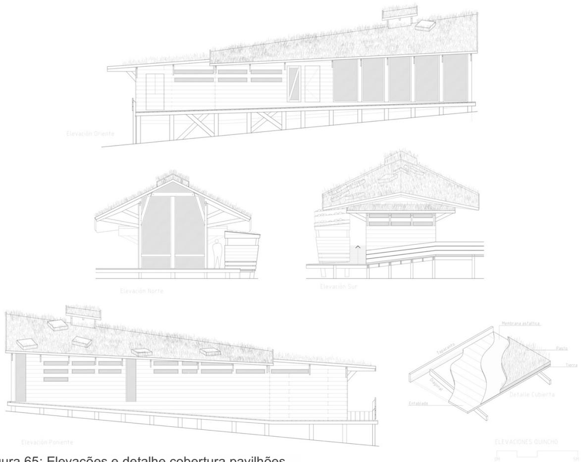
Figura 65: Elevações e detalhe cobertura pavilhões
