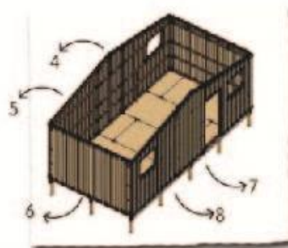
ETAPA 3 - COLOCAÇÃO DOS PAINÉIS DE PISO E DETALHE DA FIXAÇÃO ENTRE ELES
