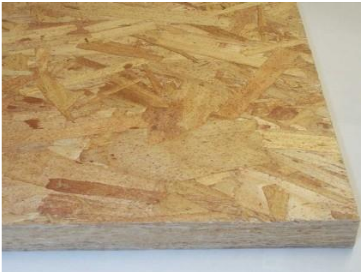
FIGURA 26 – CHAPAS DE OSB UTILIZADAS NO SISTEMA CONSTRUTIVO
