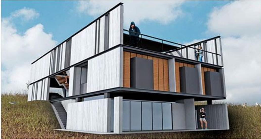
FIGURA 5.25 – Modelo tridimensional de projeto com estrutura metálica e painéis de concreto.
