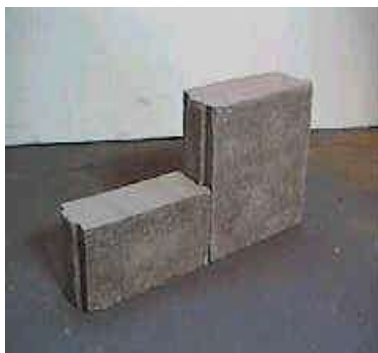
Figura 28 e 29 – Blocos de isopet, modelo de encaixe (à esquerda), unidade experimental (à direita).
