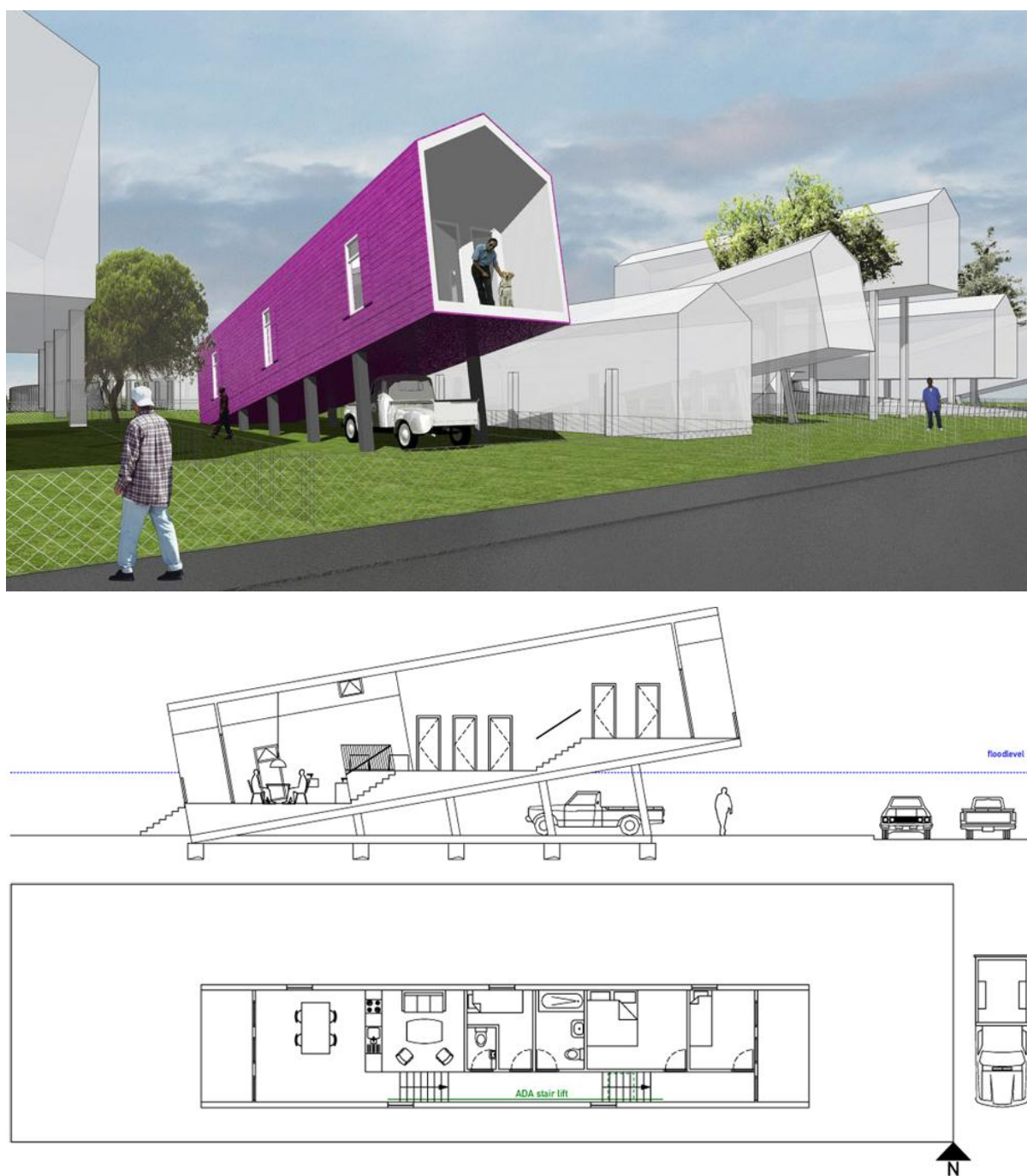
FIGURA 3.29 – Perspectiva, corte e planta da casa inclinada.
