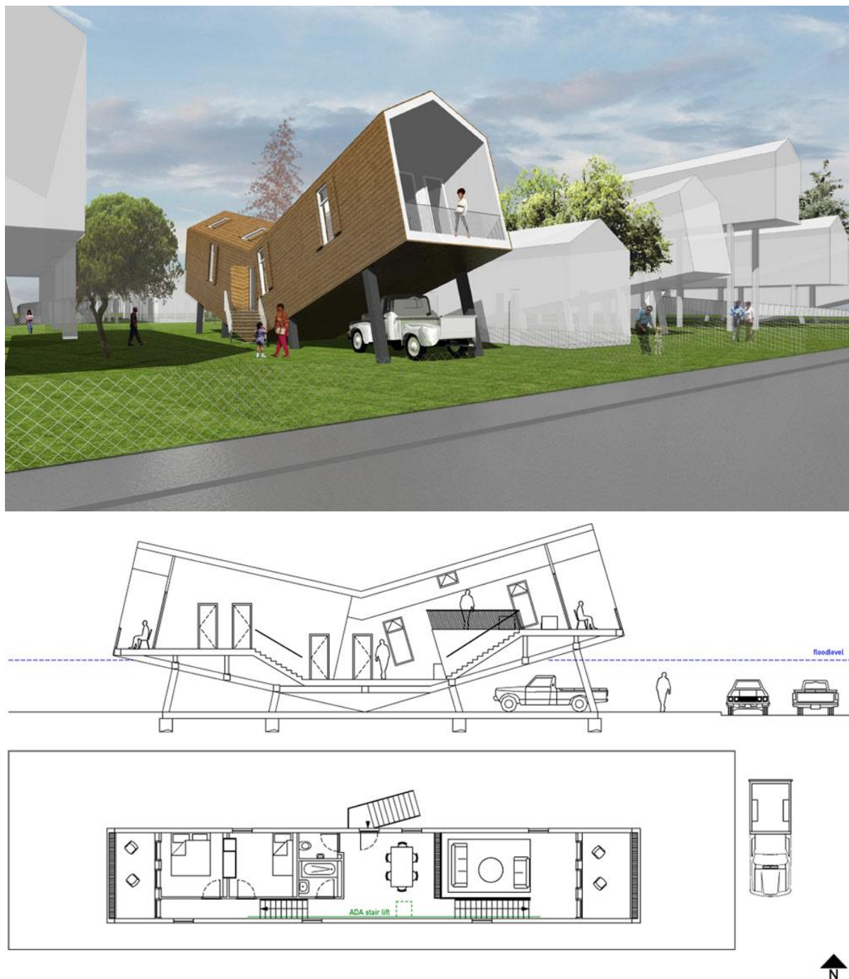
FIGURA 3.32 – Perspectiva, corte e planta de uma Bent House . (FONTE: Europa Concorsi, 2011).
