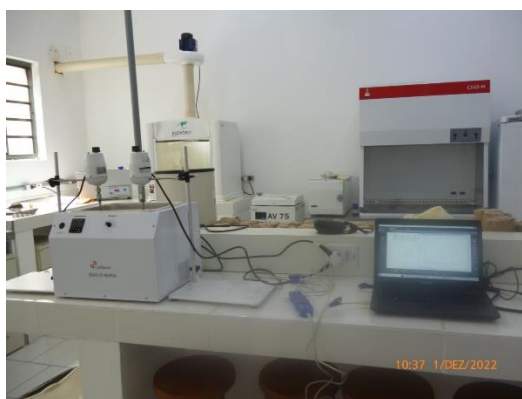
FIGURA 1 – Sistema utilizado para aplicação da pasteurização em leite cru.
