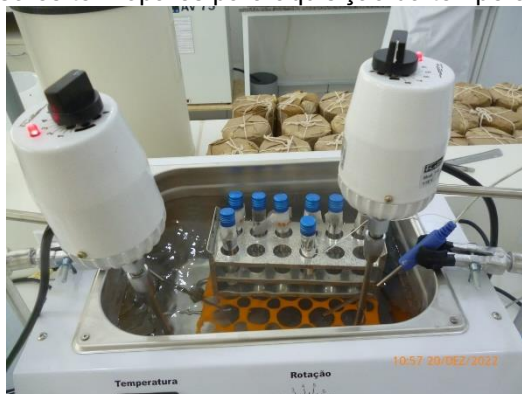
FIGURA 2 – Aplicação da pasteurização no leite em banho térmico com agitadores mecânicos e sensores termopares para aquisição da temperatura.
