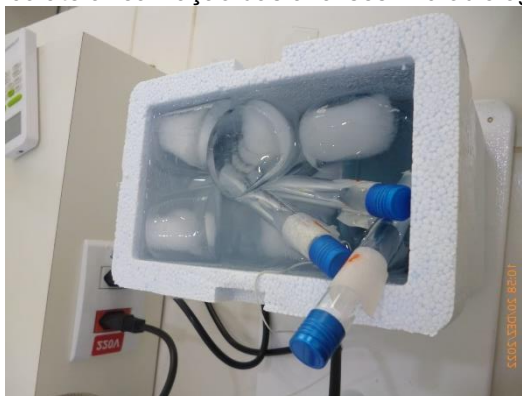
FIGURA 3 – Banho de gelo para o acondicionamento das amostras após a aplicação do tratamento térmico até a realização das análises microbiológicas.
