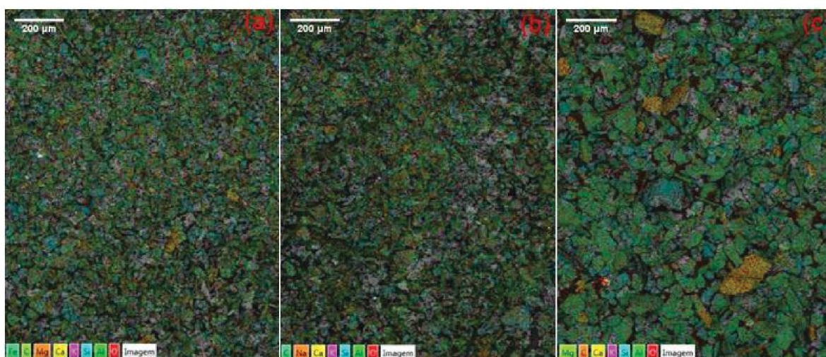
FIGURA 37 – MAPEAMENTO QUÍMICO POR SEM-EDS COM UMA AMPLIAÇÃO DE 200x DAS CINZAS DOS RESÍDUOS DAS MÁQUINAS A, B E C
