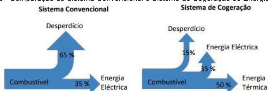
Figura 5 - Comparação do Sistema Convencional e Sistema de Cogeração de Energia Elétrica
