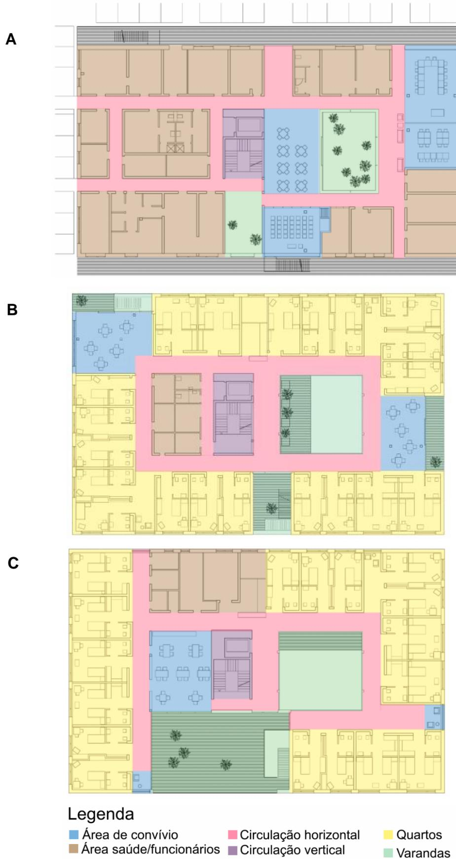
**Figura 3.2.7** – Plantas do pavimento térreo [A], primeiro pavimento [B] e segundo pavimento [C] do *Lar de Repouso e Cuidados Especiais* de Leoben (Áustria). **Fonte:** Archdaily (2016f/g/h), adaptada
