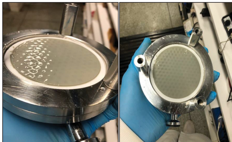
FIGURA 24 – REPRESENTAÇÃO DO CONCENTRAÇÃO DE SOLUTO NA INTERFACE DA MEMBRANA
