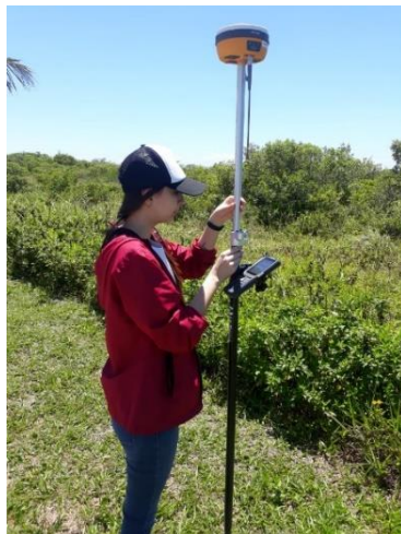
FIGURA 3.6 – POSICIONAMENTO DO ROVER NOS PONTOS QUE SE DESEJA CONHECER AS COORDENADAS
