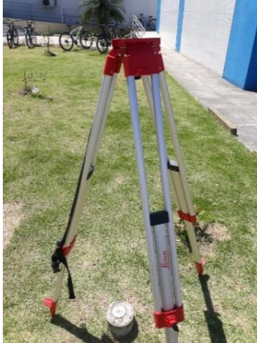
FIGURA 3.4 – NIVELAMENTO DA BASE NO PONTO CPP002
