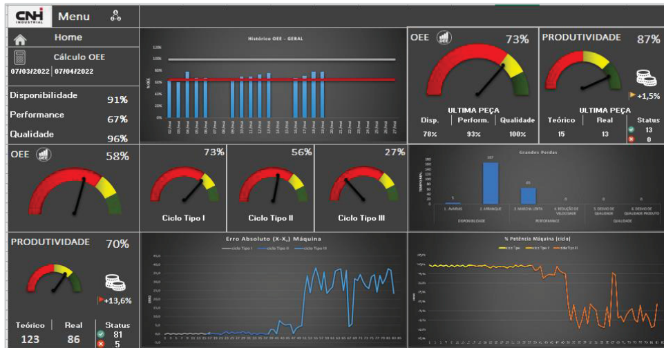
FIGURA 19 – MODELO DO PAINEL DIGITAL DESENVOLVIDO PARA VISÃO DO OPERADOR
