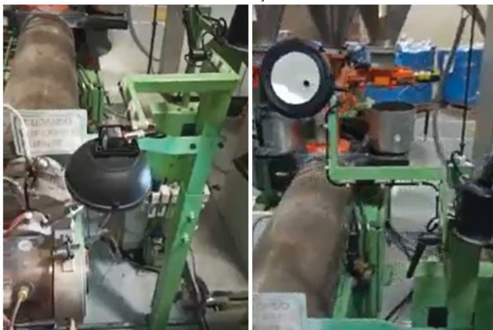
FIGURA 24 - SUPORTE FABRICADO PARA SENSOR E DOMO COM DUAS ÚNICAS POSIÇÕES POSSÍVEIS
