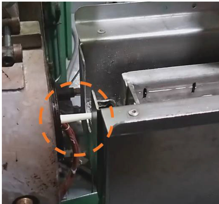
FIGURA 19 - DILATAÇÃO DO TUBO PÓS-MOLDAGEM NO CABEÇOTE
