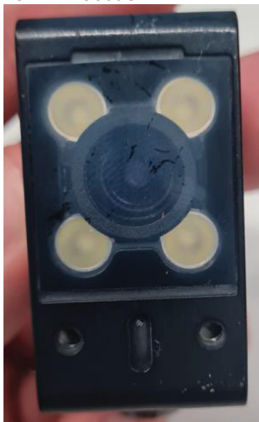
FIGURA 27 – MANCHA DE NÉVOA ADERIDA NA FACE INTERNA DA LENTE DO SENSOR IV2-G500CA
