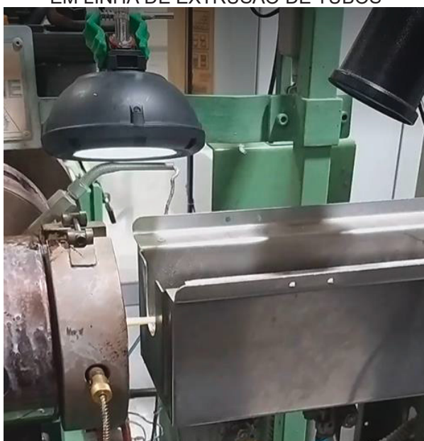
FIGURA 22 - SENSOR DE VISÃO COM O DOMO INSTALADO PARA TESTES EM LINHA DE EXTRUSÃO DE TUBOS
