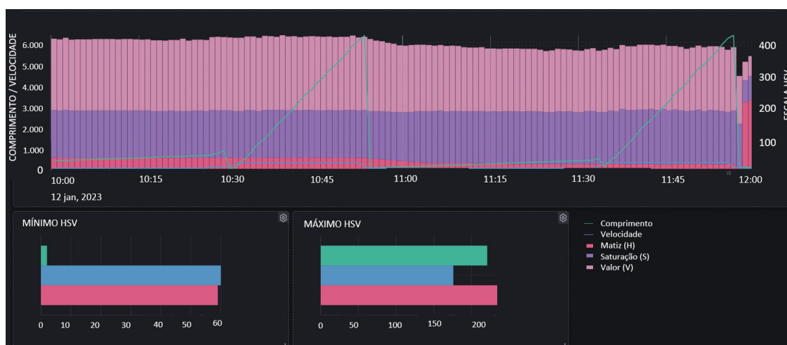
FIGURA 37 - DASHBOARD CAPTURANDO O EXATO MOMENTO DE UMA TRANSIÇÃO DE AMARELO PARA LARANJA E OS RESPECTIVOS MÁXIMOS E MÍNIMOS HSV DO PERÍODO RETRATADO
