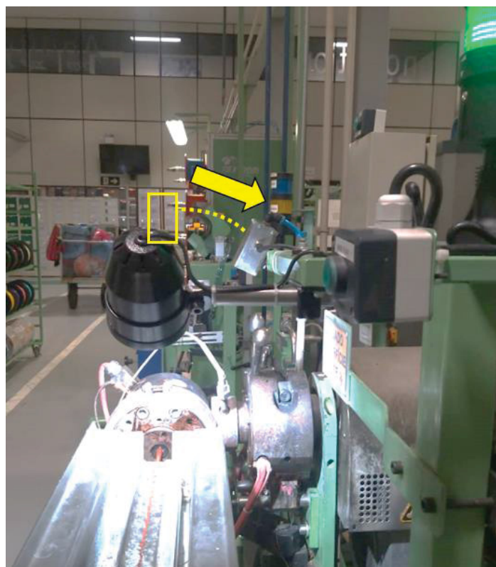
FIGURA 30 - SENSOR DESLOCADO RADIALMENTE PARA DESVIAR DE INCIDÊNCIA DIRETA DE VAPORES DO CABEÇOTE
