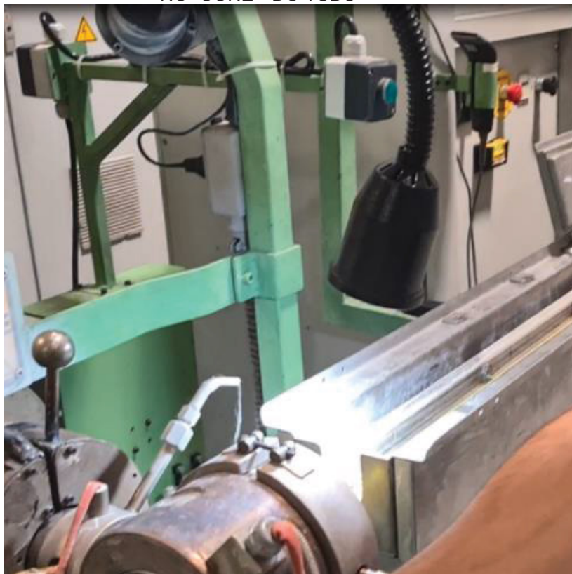
FIGURA 20 - LUMINÁRIA MÓVEL PARA FACILITAR INSPEÇÃO DE COR NO “CONE” 4 DO TUBO
