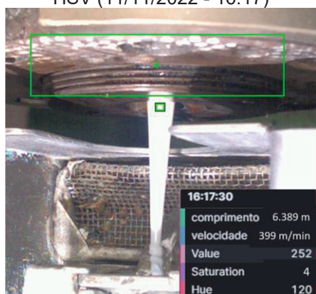
FIGURA 33 - CAPTURA TUBO BRANCO E RESPECTIVA LEITURA HSV (11/11/2022 - 16:17)
