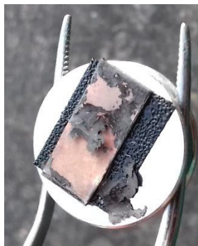
Figura 22. Amostras de substrato de cobre tratada termicamente a 450 °C por 2 horas.
