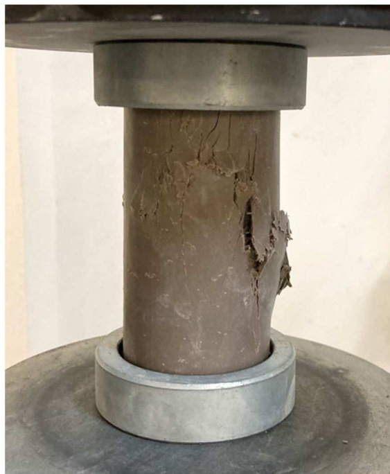
Figura 27 - Ruptura do corpo de prova cilíndrico no ensaio de resistência à compressão axial
