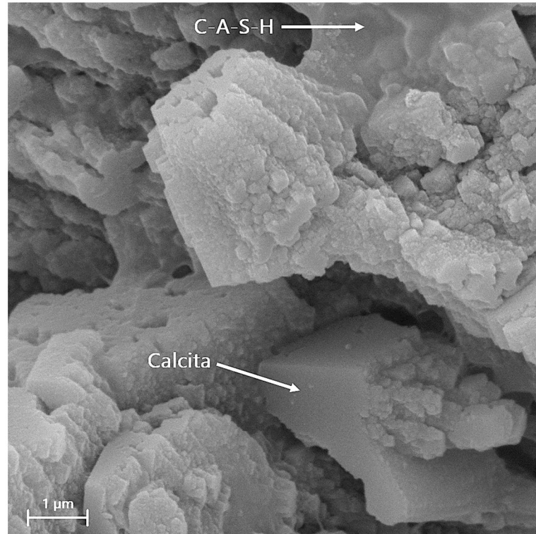
Figura 51 - Micrografia dos compostos formados sobre a região da calcita precipitada da matriz do geopolímero na amostra R10
