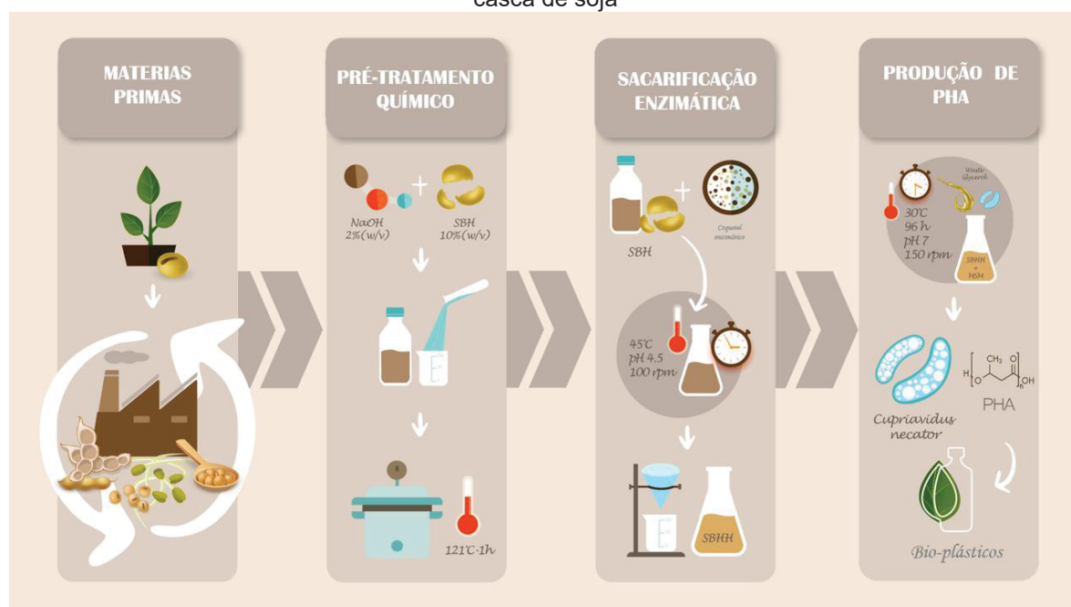
FIGURA 6 – Etapas de produção de polihidroxicanoatos a partir de glicerol residual e hidrolisados de casca de soja
