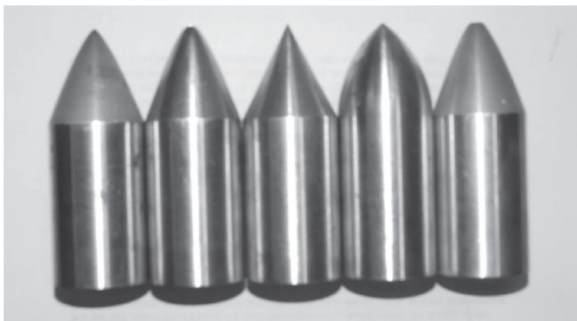
Figura 2.2 – Formatos testados: (esquerda para direita) 3/4 de potência, AMNG, cone padrão, ogiva tangente e o novo formato de nariz. Schinetsky et al. (2015) p 1576.
