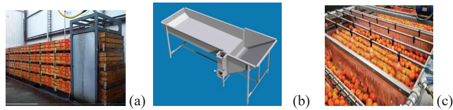
FIGURA 3 - Etapas de lavagem caixas e frutos: Drencher (a) Balsa (b) Lavadora (c) FONTE: Aruá (2021).
