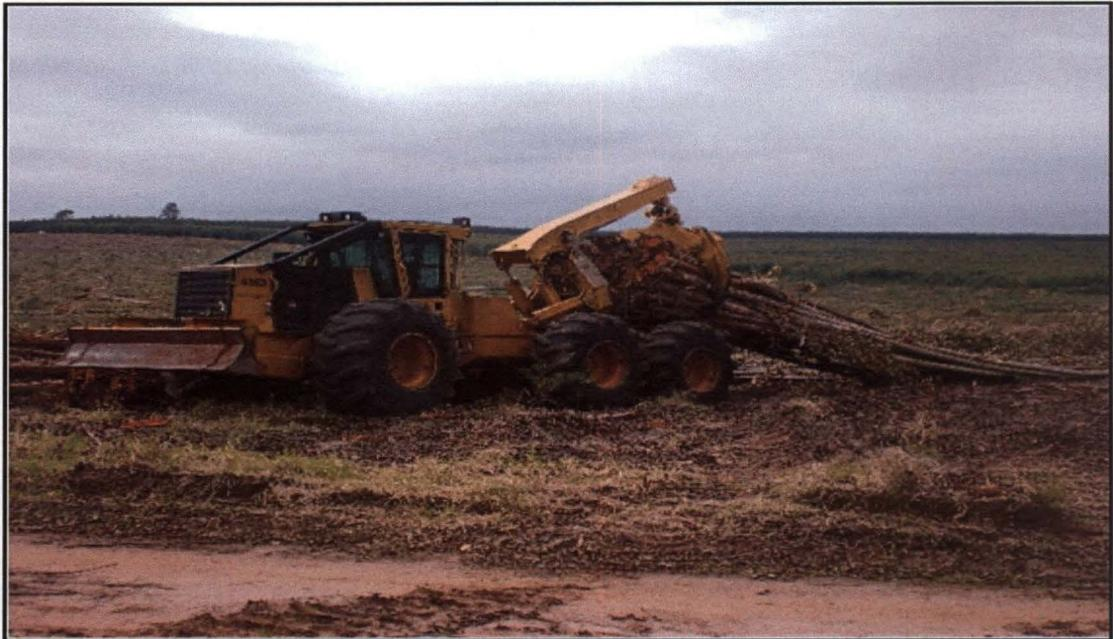
Figura 3.5 – Foto de um *Skidder* 6 x 6 com garra.
