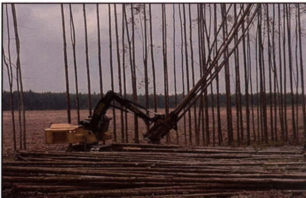
Figura 3.3 – *Feller Buncher* na operação de derrubada.
