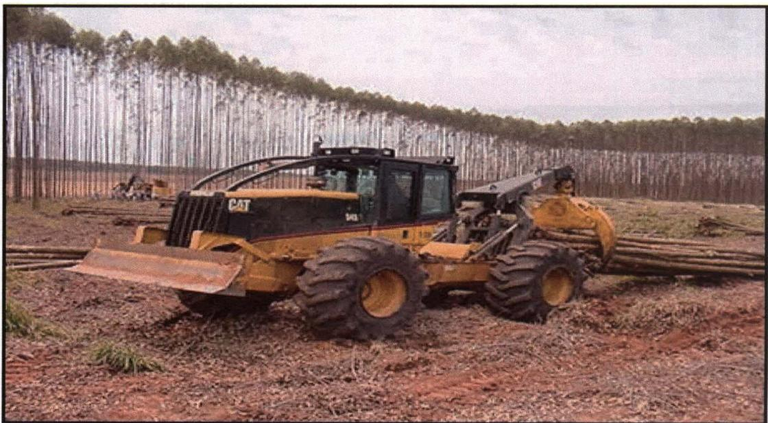
Figura 3.4 – Foto de um *Skidder* 4 x 4 com garra.
