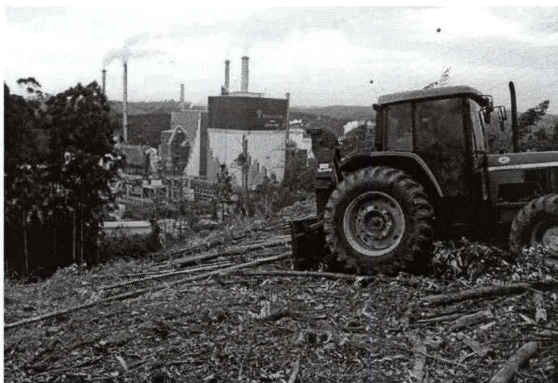
Quadro 8. Trator com Guincho de Arraste
