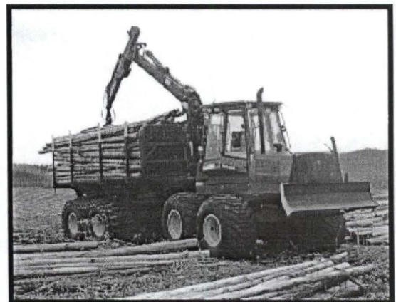
Figura 15: Forwarder em operação
