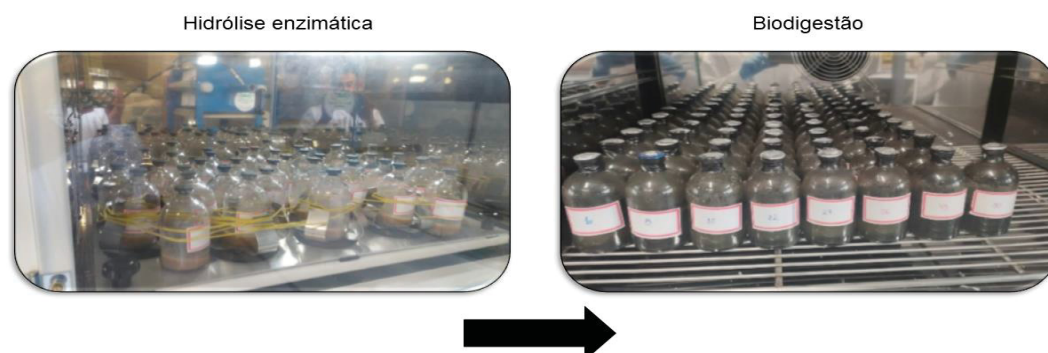
FIGURA 41- ILUSTRAÇÕES EXPERIMENTAIS DA ETAPA DE HIDRÓLISE ENZIMÁTICA EM SHAKER a 28 °C E 90 RPM DURANTE 72 h E DO PROCESSO DE BIODIGESTÃO EM ESTUFA A 35 °C DURANTE 10 DIAS
