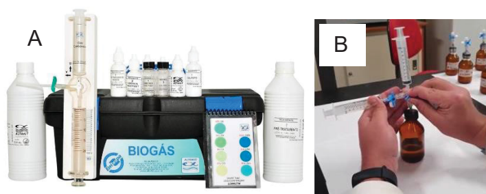
FIGURA 16- KIT DE ANÁLISE DE BIOGÁS ALFAKIT (A) E MODELO DE VERIFICAÇÃO DE BIOGÁS (B)
