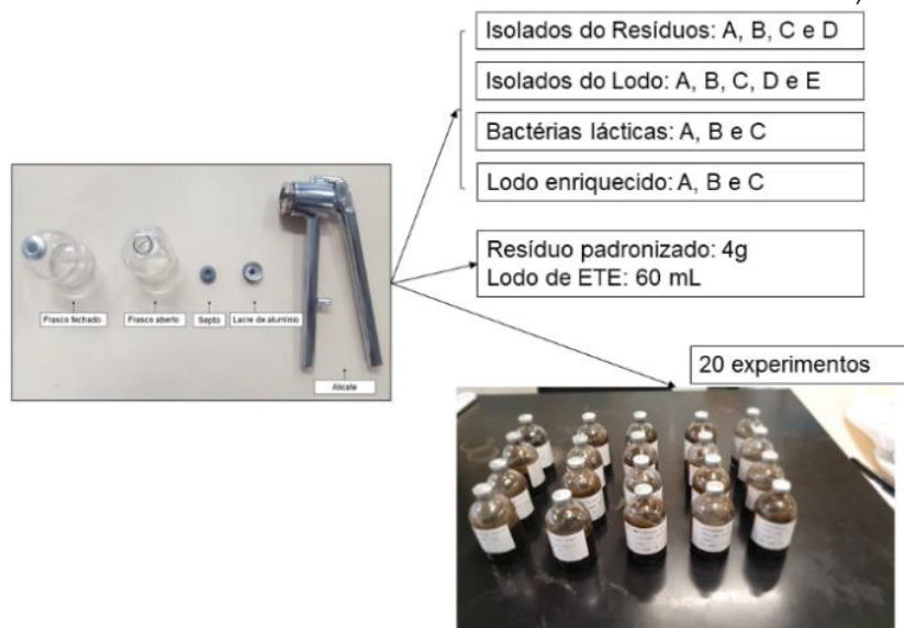
FIGURA 24- DEMONSTRAÇÃO DA MONTAGEM DOS ENSAIOS PARA DELINEAMENTO EXPERIMENTAL DO TIPO PB (RESÍDUO; LODO ENRIQUECIDO (ISOLADO); BACTÉRIAS LÁCTICAS E LODO ENRIQUECIDO)
