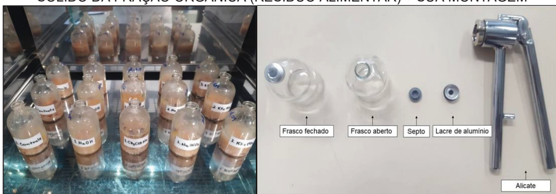
FIGURA 11- DEMONSTRAÇÃO DOS BIODIGESTORES EM FRASCOS DE 100 mL COM RESÍDUO SÓLIDO DA FRAÇÃO ORGÂNICA (RESÍDUO ALIMENTAR) + SUA MONTAGEM
