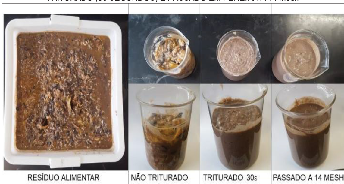
FIGURA 15- ENSAIO DE GRANULOMETRIA NO RESÍDUO ALIMENTAR NÃO TRITURADO E TRITURADO (30 SEGUNDOS) E PASSADO EM PENEIRA A 14 mesh
