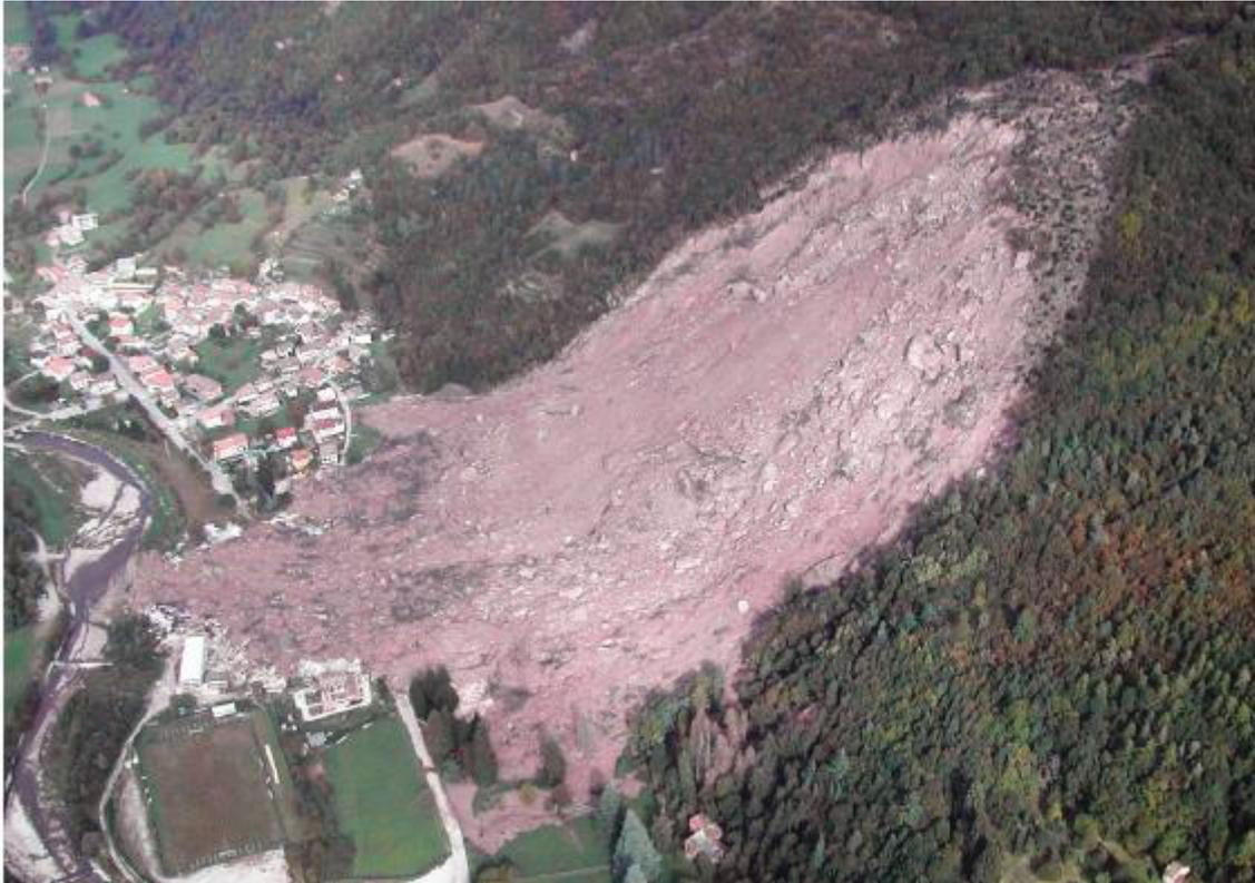
Fig. 21: Exemplo de avalanche de detritos em Cortenova, Itália, em 2002, com 1,2 milhões de m<sup>3</sup> de detritos. O evento foi desencadeado pela reativação de um deslizamento translacional de detritos previamente depositados, devido a um período de intensa infiltração de água (Hungri et al., 2014).
