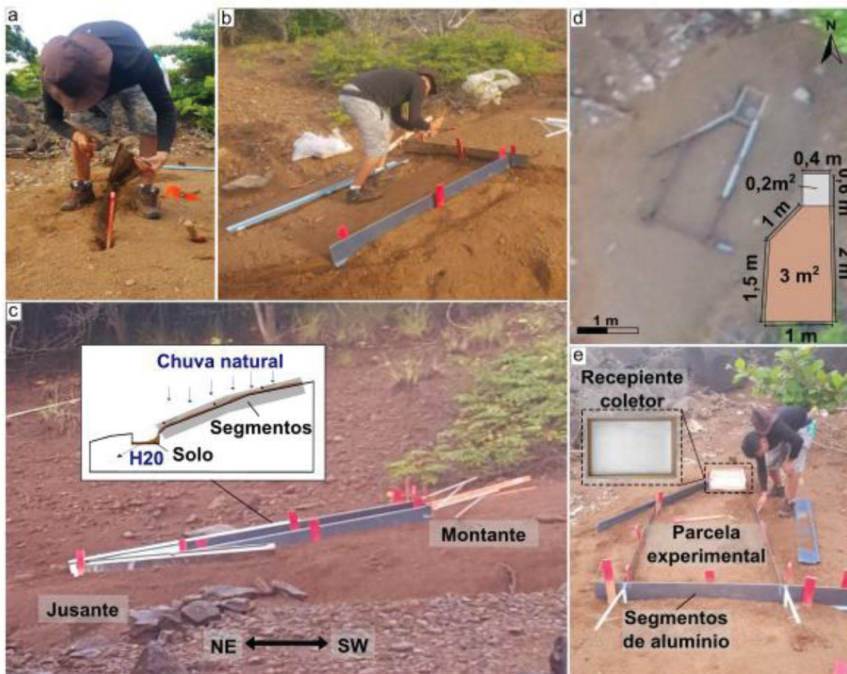
Fig. 45: Detalhes da parcela experimental na Ilha da Trindade: (a) e (b) instalação dos segmentos para delimitar a área da coleta na encosta, (c) visão em perfil em campo e desenho esquemático, (d) vista em planta por meio de fotografia aérea obtida pelo método aerofotogramétrico de Veículo Aéreo não Tripulado (VANT) e desenho esquemático com as dimensões e (e) materiais utilizados em campo.
