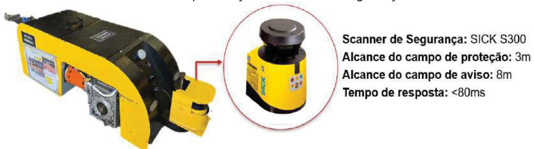
FIGURA 24 - Especificação do sensor de segurança do AGV
