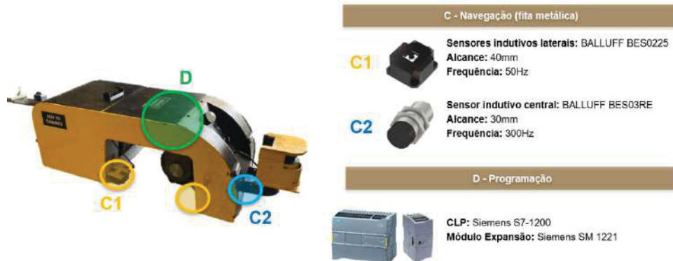
FIGURA 29 - Características técnicas do modelo do AGV selecionado – navegação e programação
