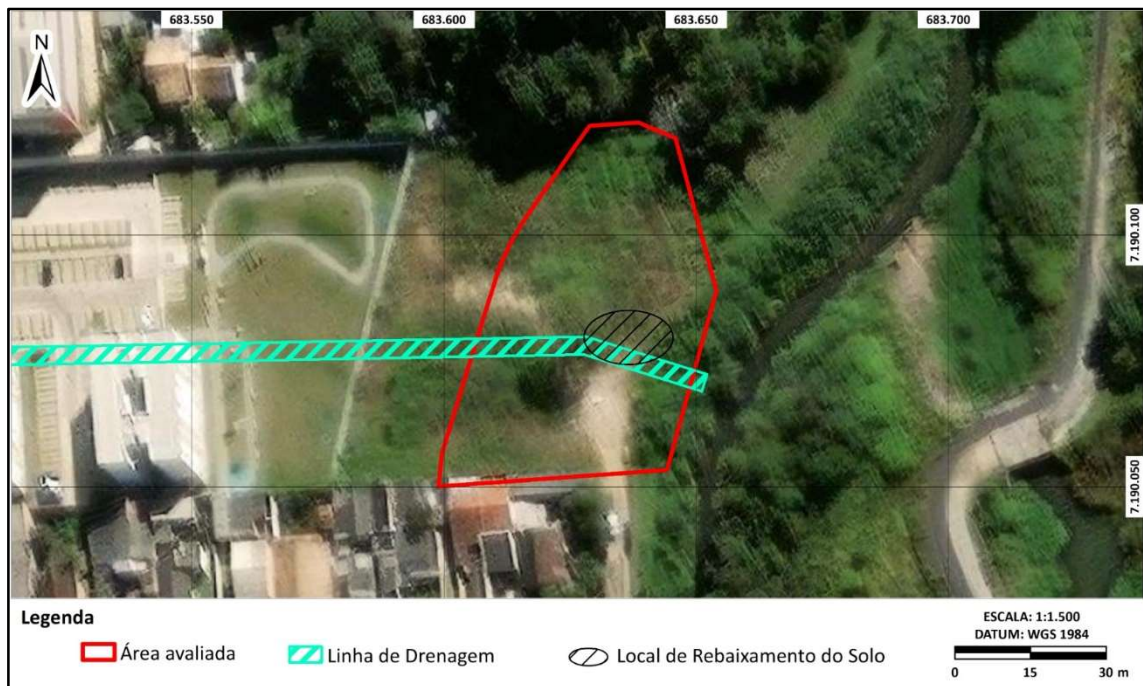
Figura 18 – Local de rebaixamento do solo (colapso de manilhas de drenagem).
