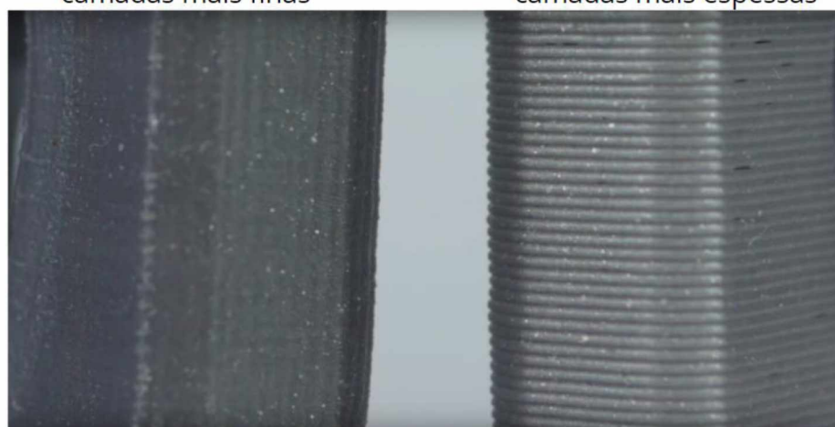
FIGURA 9 – DIFERENÇA DE ACABAMENTO ENTRE PEÇAS, UMA UTILIZANDO CAMADAS MAIS FINAS E OUTRA CAMADAS MAIS ESPEÇAS
