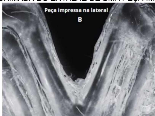
FIGURA 39 – FOTO APROXIMADA DO ENTALHE DE UMA PEÇA IMPRESSA LATERALMENTE
