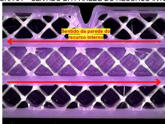
FIGURA 54 – SENTIDO DA PAREDE DO RECURSO INTERNO
