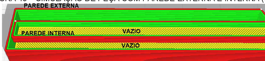
FIGURA 43 – SIMULAÇÃO DE PEÇA COM PAREDE EXTERNA E INTERNA (0E 0I)
