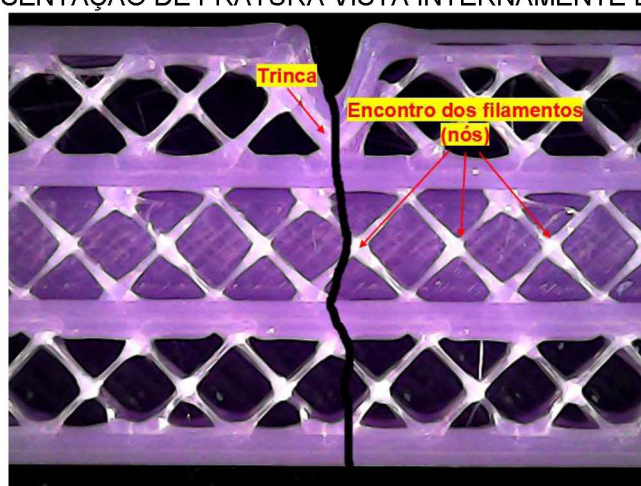
FIGURA 55 – REPRESENTAÇÃO DE FRATURA VISTA INTERNAMENTE EM UMA PEÇA 20E 20I
