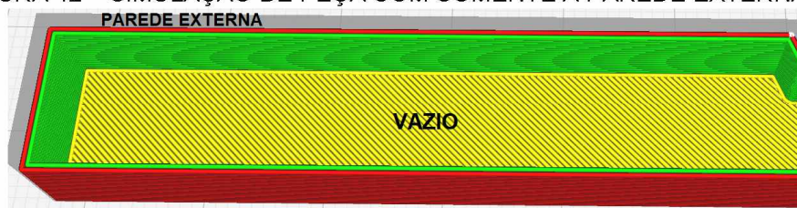
FIGURA 42 – SIMULAÇÃO DE PEÇA COM SOMENTE A PAREDE EXTERNA (0E)
