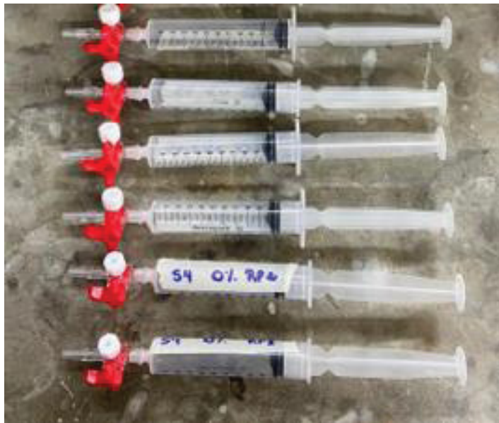
FIGURA 5 - SERINGAS UTILIZADAS PARA A COLETA DO GÁS GERADO NA DIGESTÃO ANAERÓBIA
