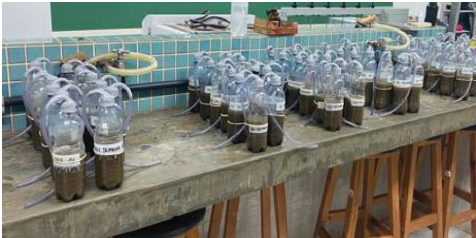
FIGURA 2 - REATORES DESTRUTÍVEIS DE GARRAFA PET UTILIZADOS PARA COLETA DO EFLUENTE
