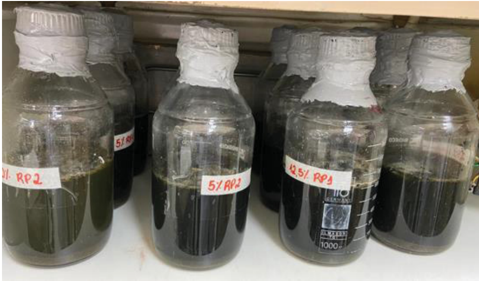
FIGURA 3 - REATORES EM FRASCOS DE VIDRO UTILIZADOS PARA COLETA DO GÁS
