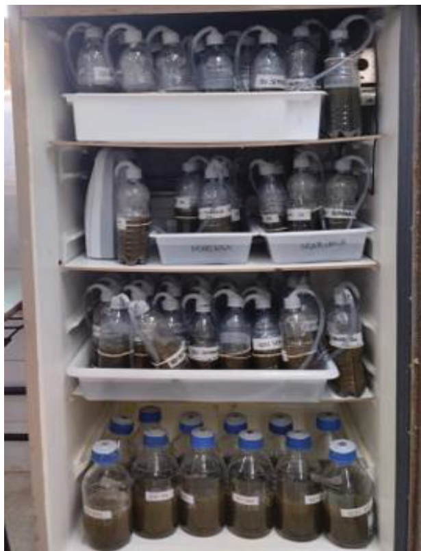
FIGURA 4 - CÂMARA COM TEMPERATURA CONTROLADA ONDE FORAM ALOCADOS OS BIORREATORES
