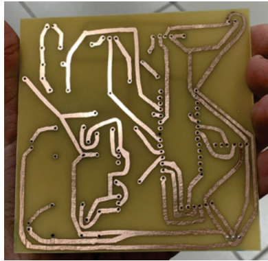
(c) Após a corrosão.
