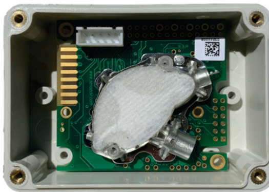
Figura 18 – Caixa usada para acondicionar o sensor K30, facilitando o fluxo de passagem do gás e impedindo a contaminação com gases do entorno.
