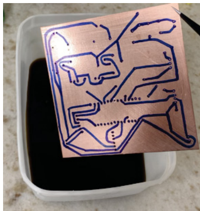
(a) Antes da corrosão.
