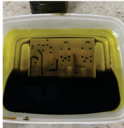
(b) Durante a corrosão.
