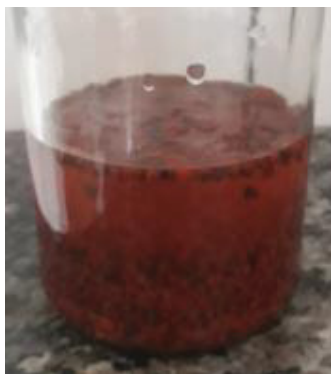
Figura 46 – Extração do pigmento bixina de sementes de urucum in natura em etanol
