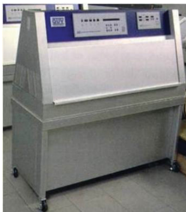
Figura 54 – Câmara de radiação ultravioleta QUV
