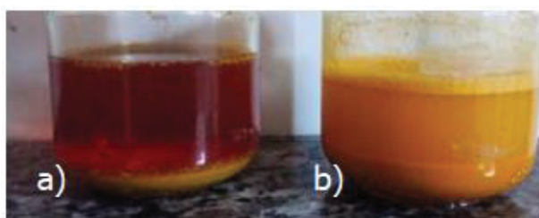
Figura 45 – Extração do pigmento curcumina em etanol (a) e água (b)
