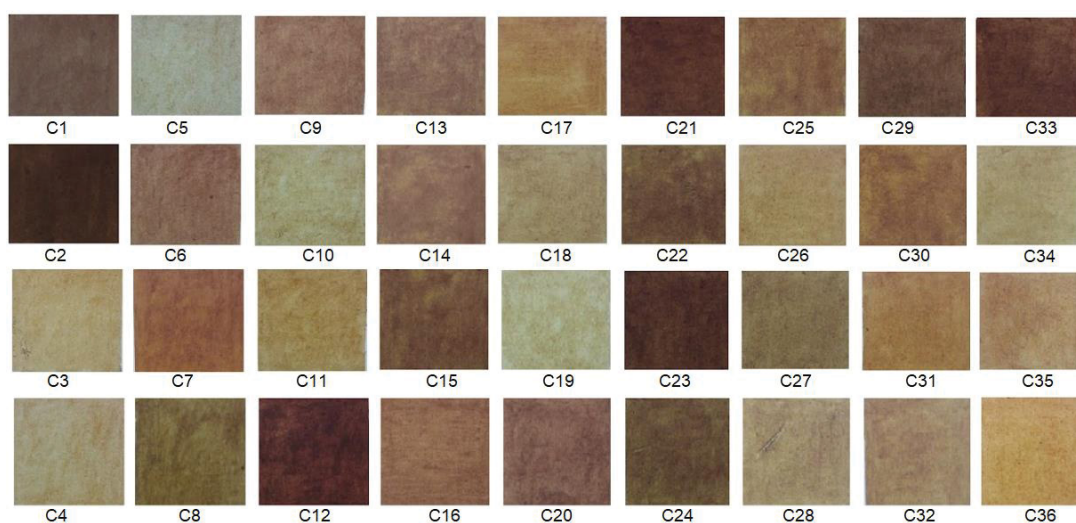
Figura 55 – Aplicação das 36 misturas de tinta com pigmento curcumina em substrato de argamassa
