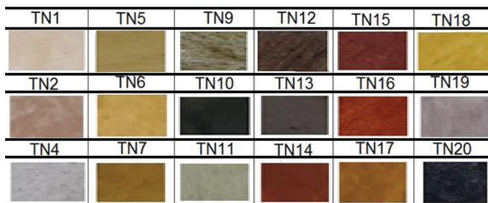
Quadro 8 – Cores das tintas TN1 a TN20 após a secagem na parede
