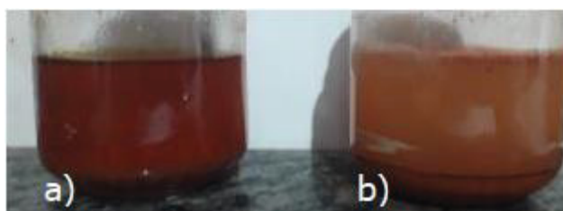
Figura 44 – Extração do pigmento bixina em etanol (a) e água (b)
