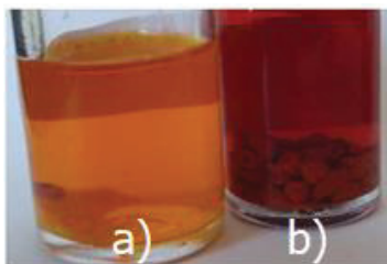
Figura 34 – Urucum em pó (a) e sementes in natura (b) imersas em acetona
