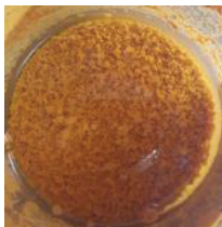
Figura 66 – Floculação do pigmento bixina em TN7
