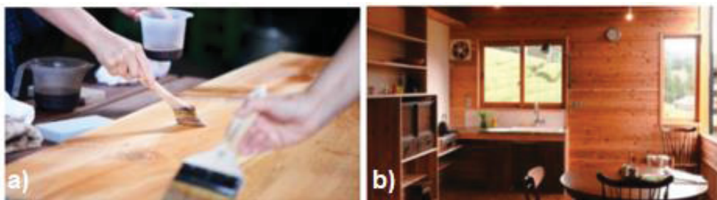
Figura 26 – Uso do kakishibu para impermeabilização de madeira
