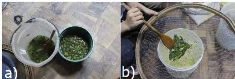
Figura 23 – Processo de elaboração do aglutinante de goma do cacto palma
