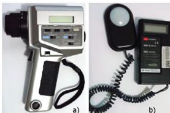
Figura 52 – Equipamentos luminancímetro (a) luxímetro (b)
