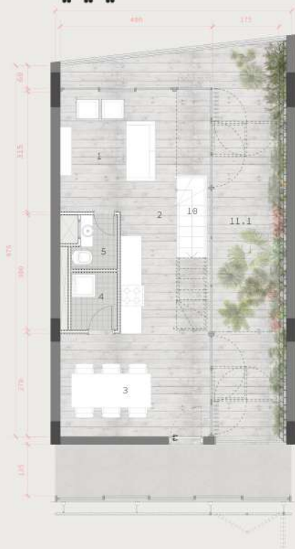
PLANTA PISO INFERIOR UNIDADE DUPLEX escala 1/50
