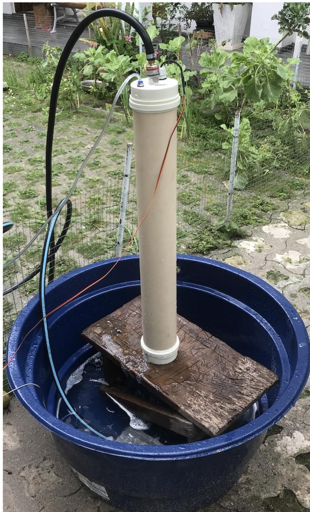
Figura 14 – Teste de vazão com o equilibrador montado sobre um banco, tendo a entrada de água pela mangueira preta e a saída por orifício na parte de baixo, a recirculação da água ocorre após ela cair de volta na caixa e sendo direcionada pela bomba e mangueira para a parte superior.
