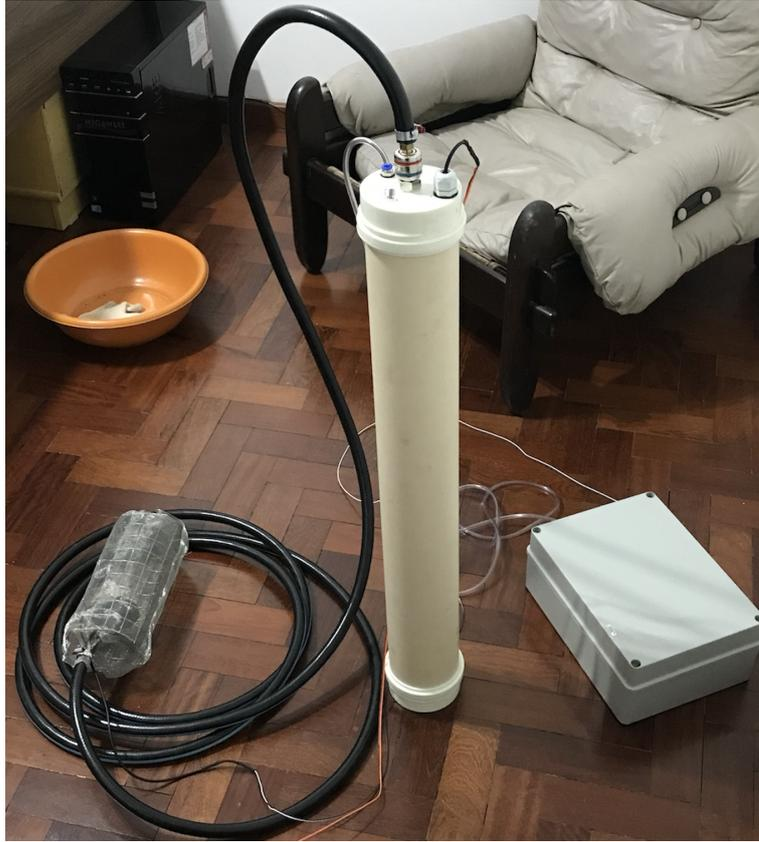
Figura 16 – Equilibrador montado (peça central confeccionada em PVC) com os engate rápido, grade de proteção da bomba (canto inferior esquerdo) e componentes eletrônicos dentro da caixa hermética (caixa cinza ao chão no canto inferior direito).
