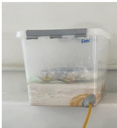
FIGURA 4. AMOSTRAS SOBRE A MESA DE TENSÃO CONSTRUÍDA.
