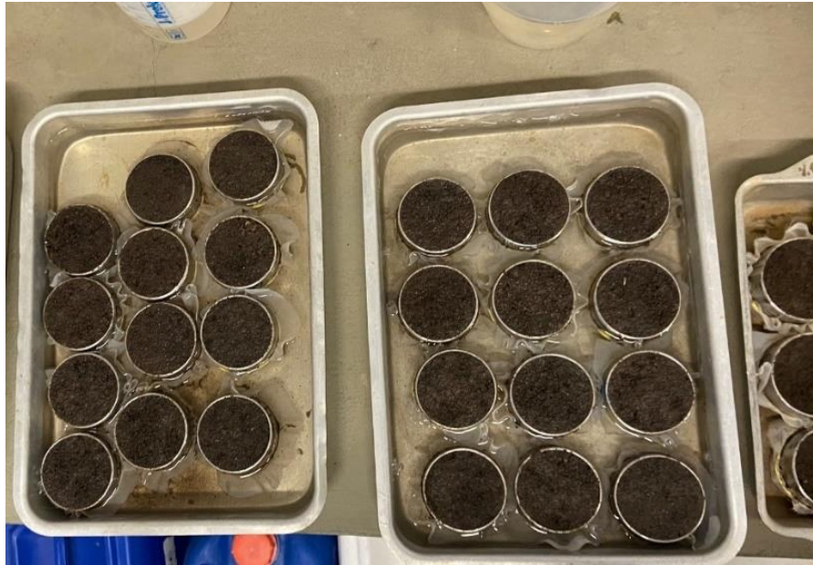
FIGURA 5. AMOSTRAS SATURANDO COM EFLUENTES INDUSTRIAIS.
