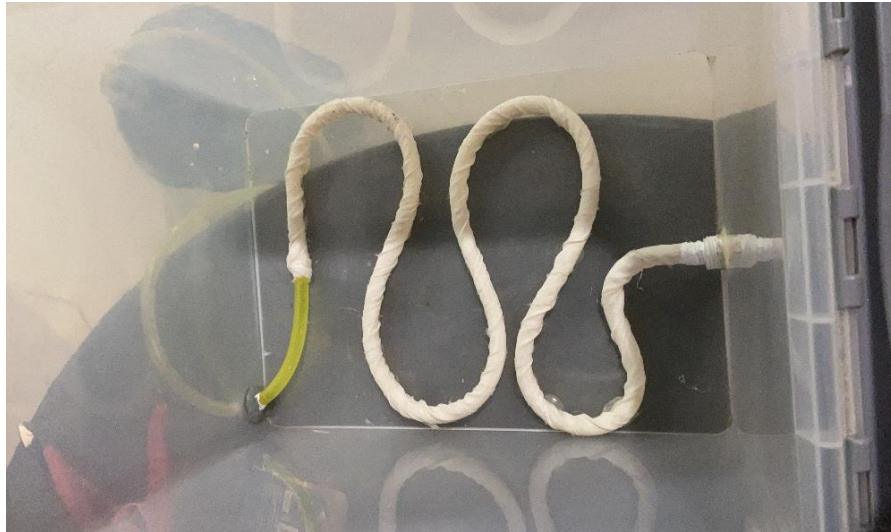
FIGURA 3 - MESA DE TENSÃO EM PROCESSO DE CONSTRUÇÃO: MANGUEIRA FIXADA ENVOLVIDA COM VOIL
