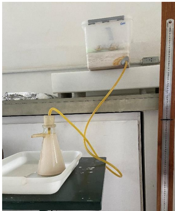
FIGURA 6. ESQUEMA DA MESA DE TENSÃO NA TENSÃO DE 6KPA.
