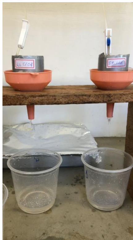
FIGURA 7: AMOSTRAS VEDADAS NO PERMEÂMETRO.
