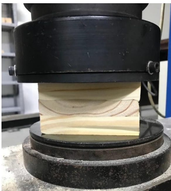
Figura 51 - Aspecto visual de um corpo de prova de MLCC de três camadas com deformação ocasionada por forças de compressão perpendicular ao plano do painel.
