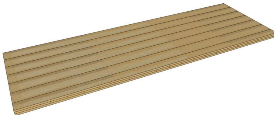
Figura 32 – Ilustração da distribuição das lamelas em um painel MLCC de três camadas.
