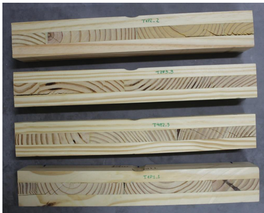
Figura 52 - Corpos de prova de cisalhamento de rolamento ensaiados à flexão de três pontos, com rupturas características de cisalhamento.
